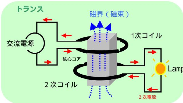
今上図のようなトランスの2次コイル両端にランプを接続し、1次コイルに交流電流を流すと2次には誘導電流が誘起されますのでランプは点灯します。これは変圧器(トランス)と呼ばれ、電柱などでよく見かけます。商用周波数(50/60Hz)のトランスでは周波数が低いので、発生させる磁界が外に漏れないようにするために鉄心(コア)を用いています。同じ交流でも高周波では1次コイルの電流変化が激しいので鉄心がなくてもトランスは構成されます。
