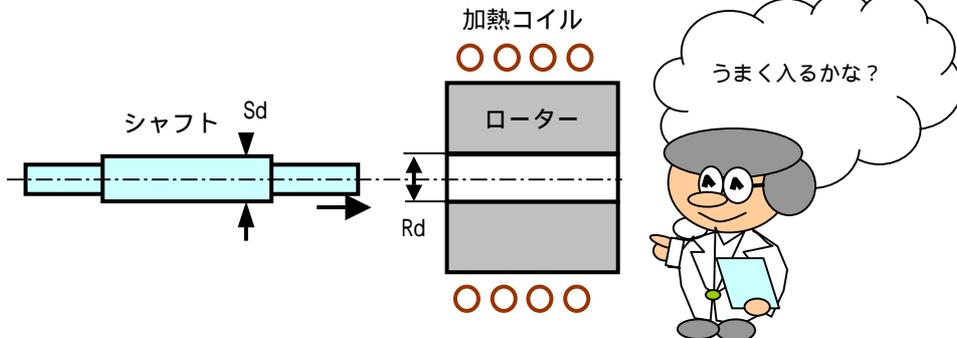
シャフト外径とローター内径の差をローターの加熱により大きくさせて組み付けます。双方の加工精度が決め手になりますが、誘導加熱は正確なローターの昇温ができますし、周囲に余分な熱を撒き散らさないで、快適、確実な作業ができます。逆のシャフト交換時など”焼き抜き”も可能です。
